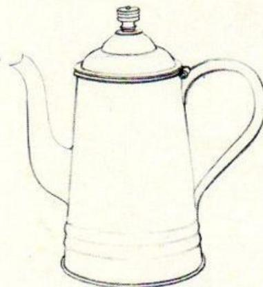
**Acima:** Em regra, a forma cônica é, de fato, parte de um cone acrescida de certos detalhes. Este bule é um cone parcial. A base e o bordo têm forma elíptica.
